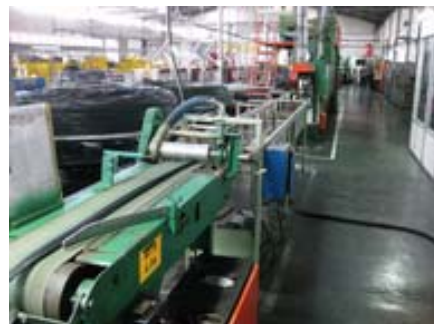
テスト材料にて製品試作を行った。写真はウェザーストリップを作成しているところ。
